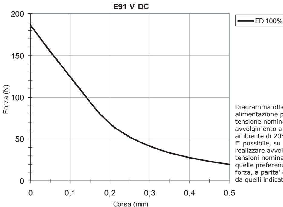
Diagramma ottenuto con alimentazione pari al 100% della tensione nominale e avvolgimento a temperatura ambiente di 20°C
