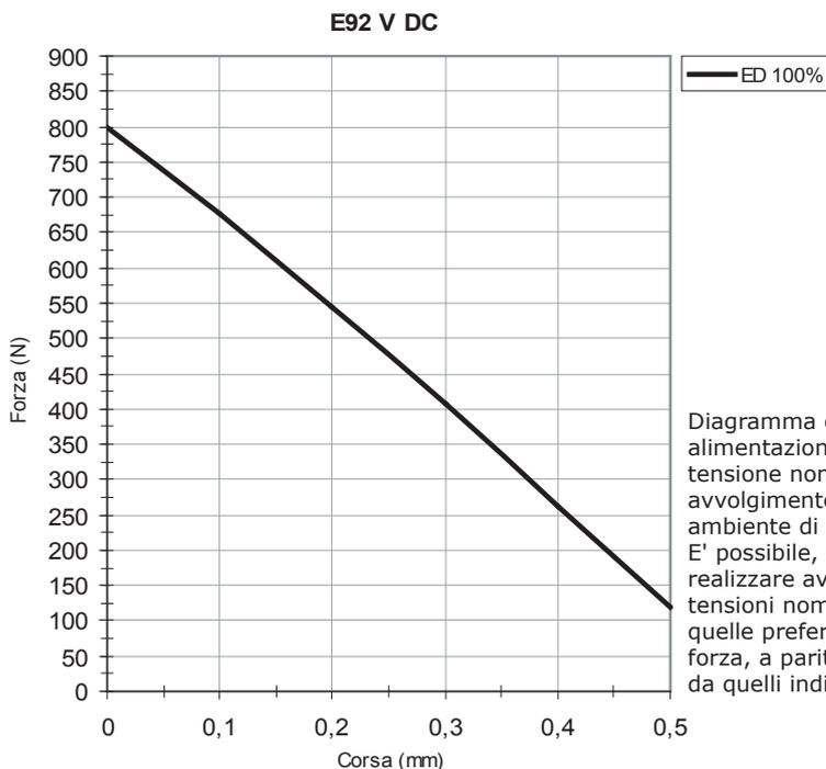
Diagramma ottenuto con alimentazione pari al 100% della tensione nominale e avvolgimento a temperatura ambiente di 20°C
